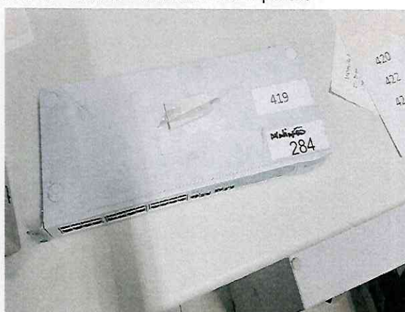
Fo Foto 101 - Switch 3com de 24 portas
