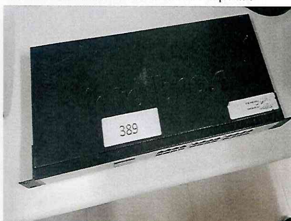
Foto 72 - Switch Intelbras de 24 portas
